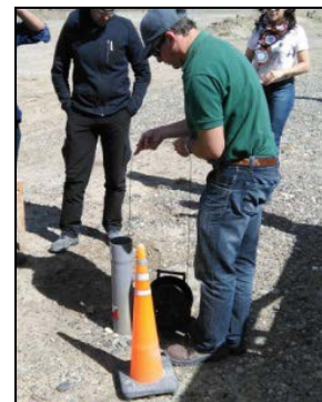
Figura 8: Medición de profundidad del nivel de agua en pozos geotécnicos existentes.
