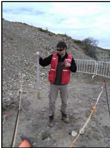
Figura 8: Toma de muestras de pozos mediante bailer, para medición de parámetros in situ.
