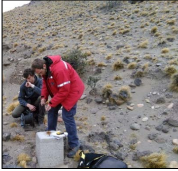
Figura 9: Relevamiento de pozos geotécnicos con agua en margen izquierda de JC.
