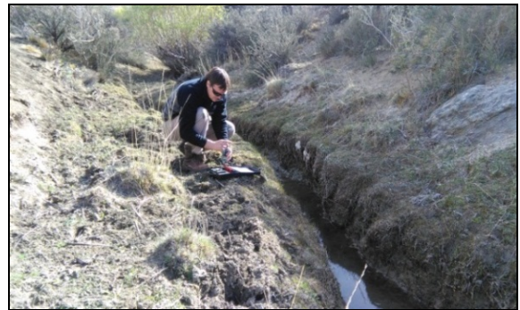
Figura 7: Medición de parámetros in situ: pH, CE y T^{\circ} en curso del cañadón El Mosquito.
